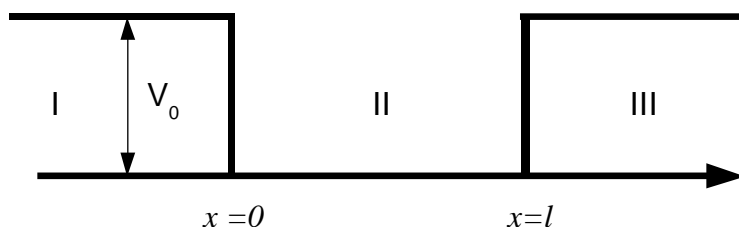
Figura 4.4. Caixa unidimensional com potencial finito nas extremidades e potencial nulo no intervalo que vai de 0 a l .
